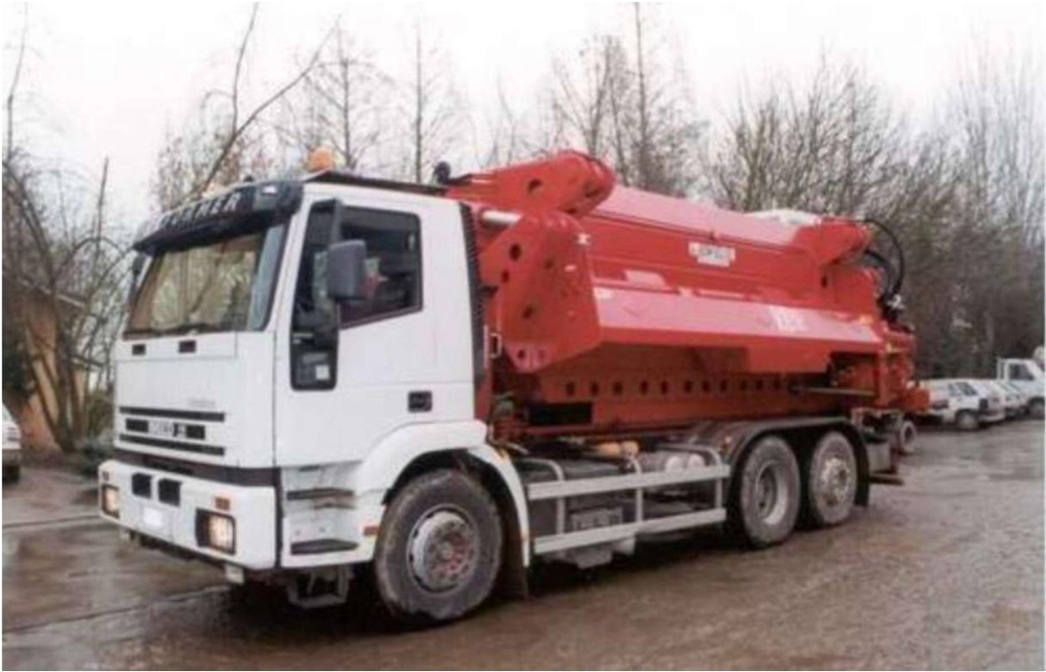
Fotografía Máquina compactadora sobre camión portacontenedores
