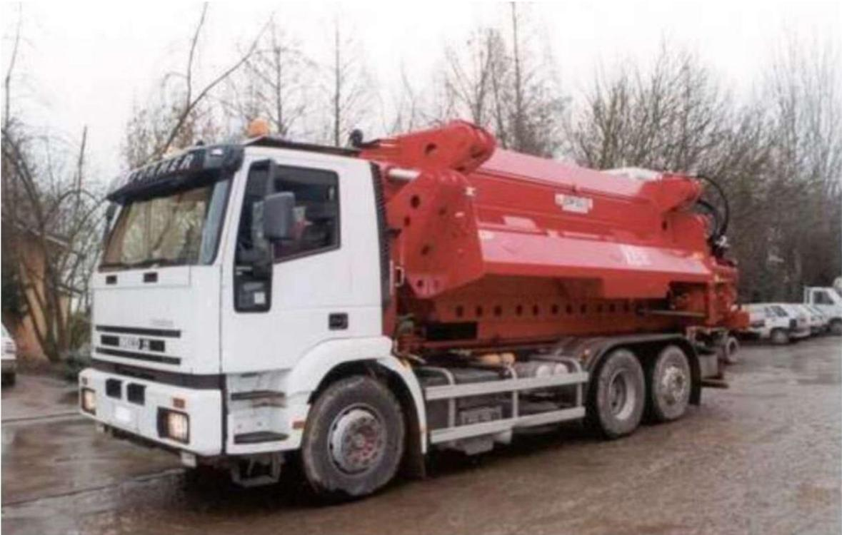
Fotografía Máquina compactadora sobre camión portacontenedores
