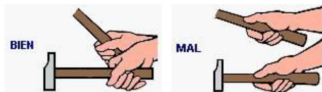
Figura 24: Forma de sujeción del mango
