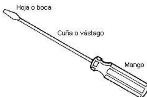
Figura 11: Partes de un destornillador
