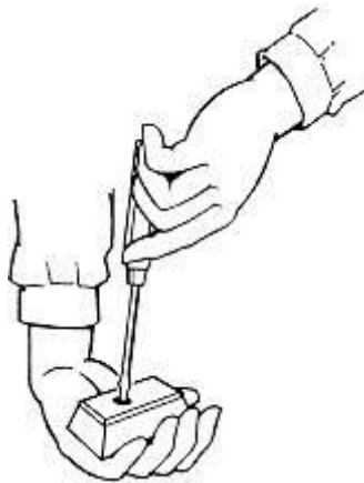
Figura 14: Sujeción incorrecta de una pieza a atornillar
