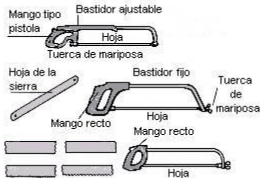
Figura 28: Partes y tipos de sierras de arco
