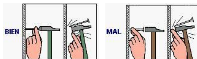
Figura 26: Forma de sujetar un clavo antes de clavarlo
