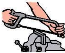
Figura 29: Pieza fijada firmemente antes de serrar
