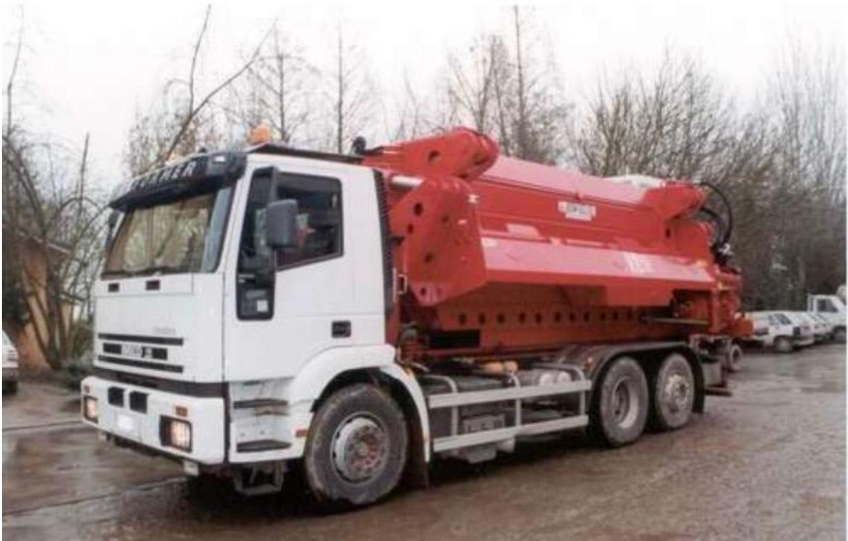
**Proyecto** Instalación de prensa compactadora móvil para gestión de residuos metálicos en parcela con licencia provisional de uso para almacenamiento de vehículos
