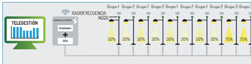
Una variante a este esquema de telegestión y control es establecer un canal de comunicaciones propio, utilizando la tecnología de radiofrecuencia, instalando un nodo de control propio para esta tecnología para cada punto de luz. Se trata de un sistema recomendado en caso de redes eléctrica poco estables (no admitirían el PLC en este caso) pero tiene el inconveniente de ser susceptible a interferencias radiofónicas y al paso de grandes objetos metálicos.
