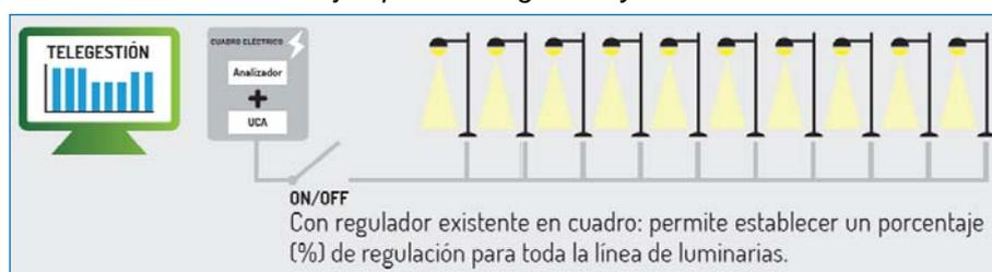
La anterior solución es habitualmente acompañada de un dispositivo estabilizador – reductor de flujo, que permitiría la regulación del flujo lumínico de todas las luminarias de la instalación en franjas horarias concretas definidas en el equipo de control, lo que significaría un ahorro considerable en horario de menor actividad en la zona iluminada.
